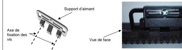
Pour contrôler les fins de courses, déverrouiller le moteur, placer le moteur à mi course puis donner une commande d'ouverture (après coupure d'alimentation électrique, la première commande est une commande d'ouverture) et déplacer manuellement le portail en ouverture de façon à faire passer l'aimant ouverture en vis à vis du moteur, ce dernier doit s'arrêter. Dans le cas contraire recommencer l'opération en inversant les aimants A et B.
