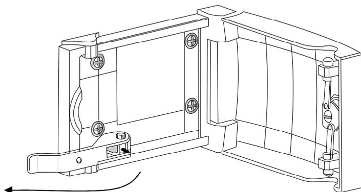
Tirer le levier dans le sens de la flèche pour déverrouiller le moteur
