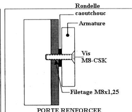
Percer un trou Ø 6,8 mm sur une certaine profondeur et fileter au Ø M8-1,25.
