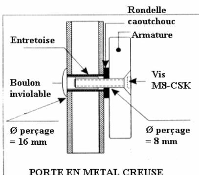
Percer un trou Ø 8 mm à travers la porte puis agrandir ce dernier au Ø 16 mm côté boulon inviolable.
