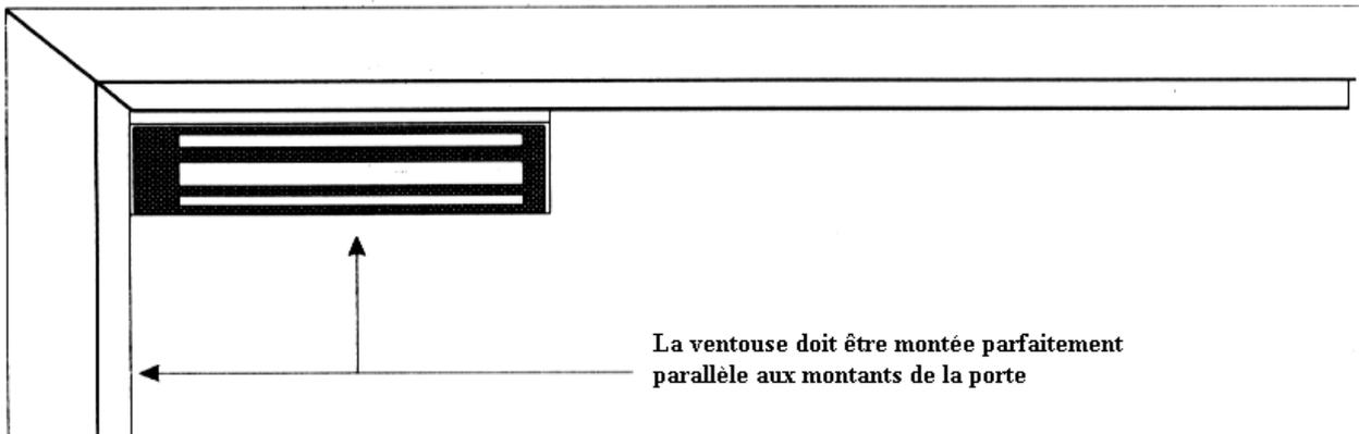
2. En fonction de la structure de la porte, disposer le gabarit pour obtenir le fonctionnement souhaité.
