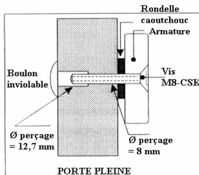
Percer un trou Ø 8 mm à travers la porte puis agrandir ce dernier au Ø 12,7 mm sur 25 mm côté boulon inviolable.
