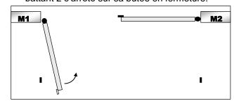
Le battant 1 s'arrête sur sa butée en fermeture (Vérifiez que le moteur 1 est bien arrêté)
