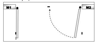
**Départ automatique du battant 1** dès que le battant 2 s'arrête sur sa butée en fermeture.
